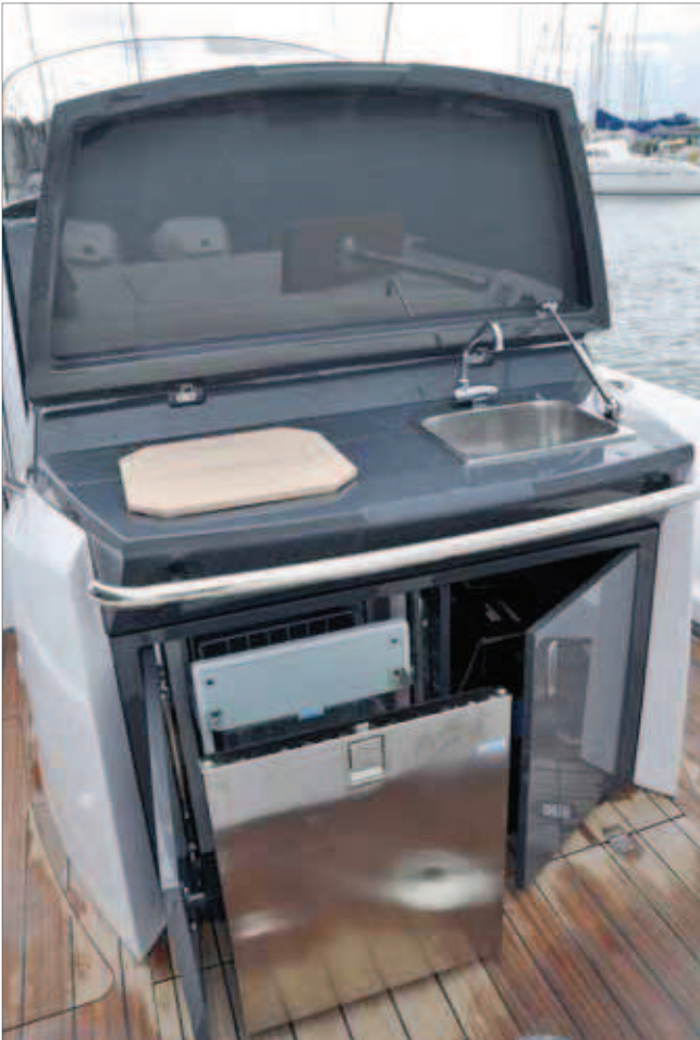
▲ La cocina, en un módulo integrado tras el puesto de gobierno, aporta superficie de trabajo, fregadero de un seno de inox, nevera y armario.
