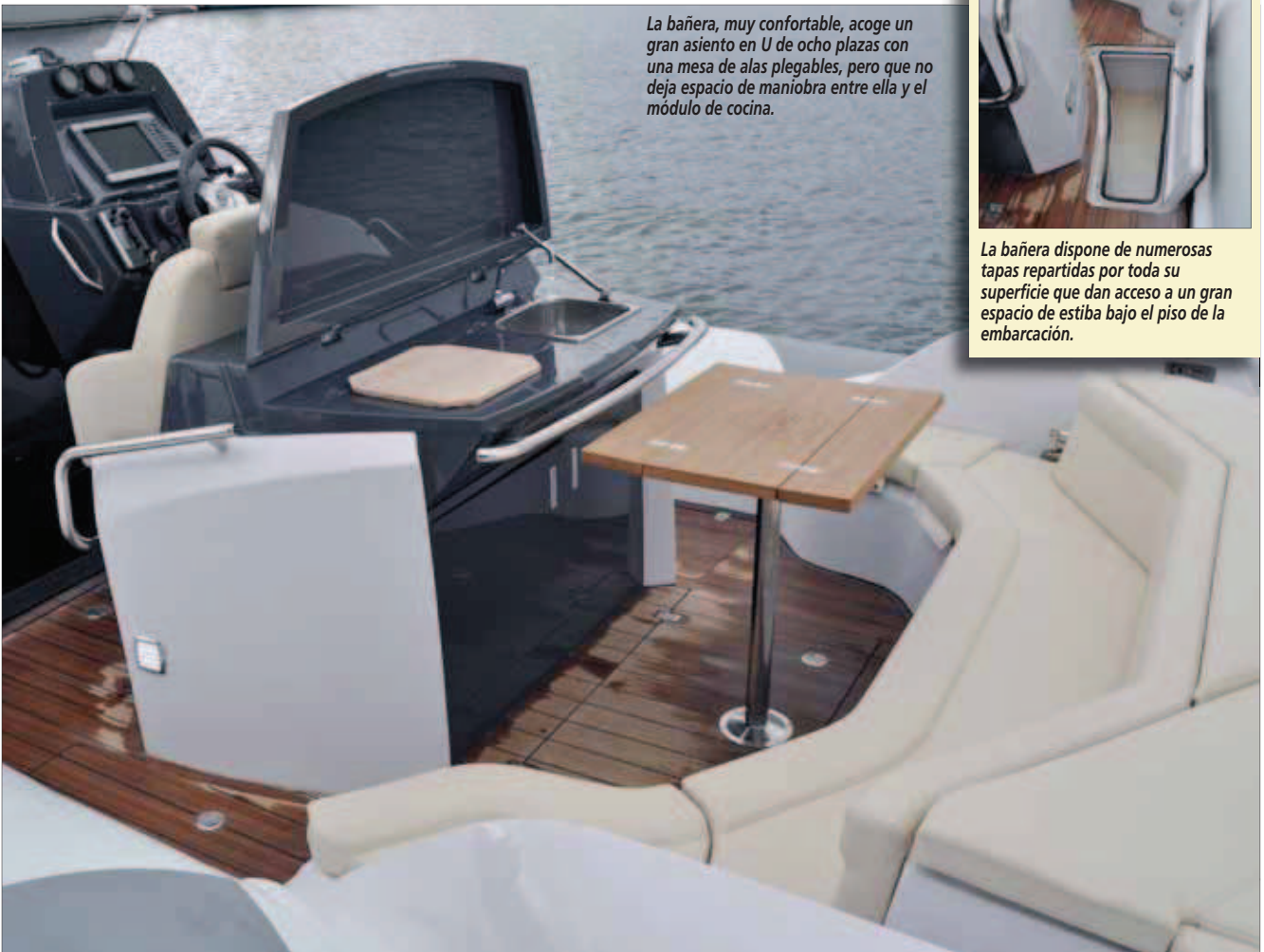
▲ La cocina, en un módulo integrado tras el puesto de gobierno, aporta superficie de trabajo, fregadero de un seno de inox, nevera y armario.
