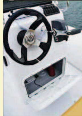
En la parte inferior de la consola, bajo la rueda, se ha ubicado un registro para acceder a un lugar de almacenaje estanco.
