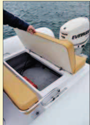
Levantando la base del asiento del puesto de gobierno alcanzaremos otro gran cofre de estiba y la sentina.
